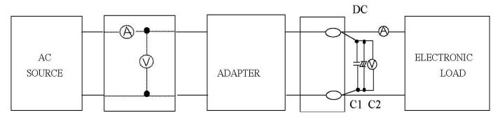
C1: 0.1uF CERAMICS CAPACITOR C2: 10uF 50V ALUMINUM CAPACITOR
